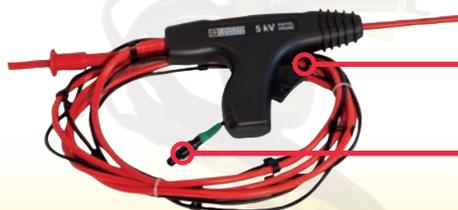
Zum Starten einer HV-Prüfung muss der Trigger >1s gehalten werden
