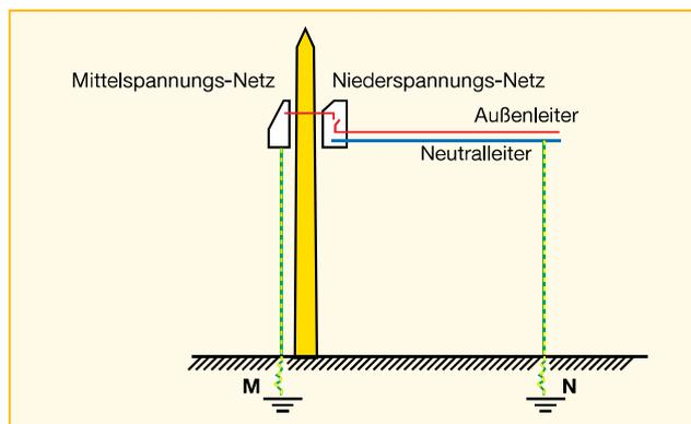
Bei einem Blitzeinschlag in einen Mittelspannungs-/Niederspannungstransformator kann das Potential vorübergehend auf mehrere kV ansteigen.
