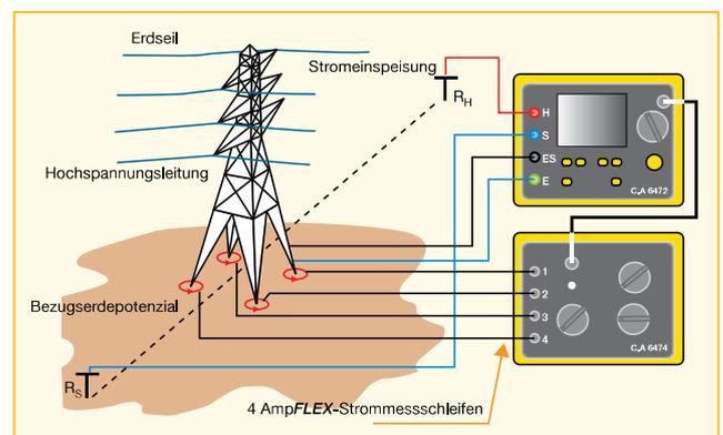
Messung einer Masterdung mit den C.A 6472 + C.A 6474
