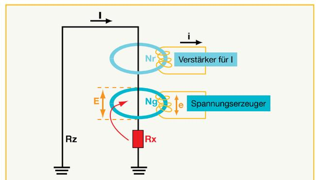
Um nur den im Erdleiter erzeugten Strom  $I$  zu messen, verwenden die Erdungsprüfzangen eine besondere Frequenz und werten nur diese aus, so dass eventuelle Fremdströme wegfallen. Wir betrachten nun den Fall einer Erdung mit mehreren parallelen Erdanschlüssen  $R_x$ ,  $R_1$ ,  $R_2$  usw... bis  $R_n$ , an der man den Erdungswiderstand  $R_x$  messen möchte. Das folgende Schaltbild soll diese Erdung darstellen:
