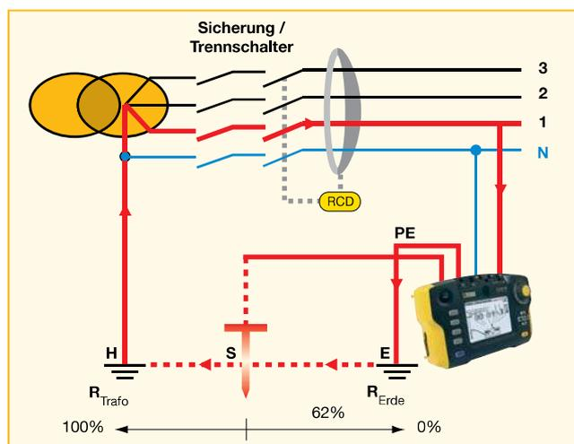
Das Messprinzip ist dasselbe wie beim 62 %-Verfahren: der Hilfserder S wird auch hier in einem Abstand von 62 % von dem Erder E in Bezug zur Entfernung zwischen E und H eingesteckt.
