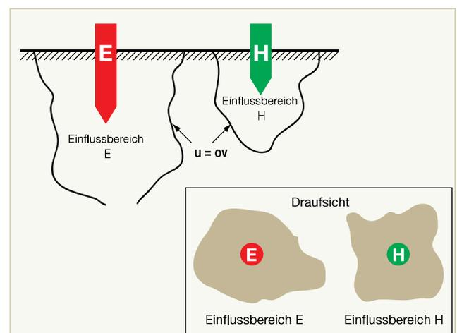
Da die Verteilung dieses Einflussbereiches im Boden vom spezifischen Erdwiderstand abhängt, ist es nicht einfach abzuschätzen, ob sich der Nullpotenzial-Erder  $S$  außerhalb eines Einflussbereiches befindet. Die beste Lösung besteht darin, den Erder  $S$  zu versetzen und eine erneute Messung vorzunehmen. Wenn sie denselben Wert liefert, ist die Messanordnung dann in Ordnung.
