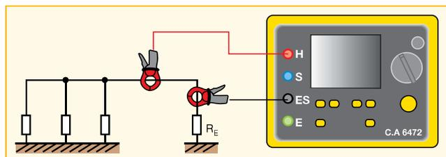
Statt einer einzigen Erdungsprüfzange verwendet man hierbei zwei Messzangen für jede der beiden Funktionen. Der Vorteil dabei ist, dass man Messungen auch an Leitern durchführen kann, die wegen Platzmangel oder wegen ihres Durchmessers nicht mit einer Erdungsprüfzange umfasst werden können.
