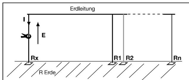
Wenn man über die Erdungsprüfzange in einem beliebigen Punkt des Erdanschlusses  $R_x$  die Spannung  $E$  erzeugt, fließt in der Erdschleife ein Strom  $I$  nach folgender Gleichung:
