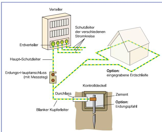
Bei jeder dieser Erdungsarten ist ihre Funktion eine gute, elektrisch leitende Verbindung zur Erde herzustellen, damit die Fehlerströme in sie abfließen können. Eine ordnungsgemäße Erdung hängt damit insbesondere von den folgenden Faktoren ab:
