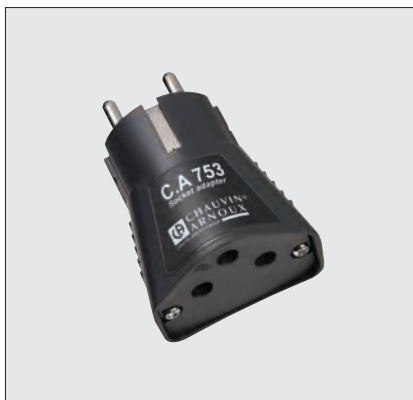
C.A 753 Adapter zur Messung an Schutzkontakt-Steckdosen P01191748Z Geeignet für alle Prüfspitzen (2 und 4 mm Ø, IP2X,...) Erkennung Außenleiter / Neutraleiter IEC 61010 230 V CAT II
