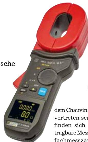
Für Blitzschutz-Überprüfungen an Bänderdämm gibt es die neue Erdschleifenprüfzange C.A 6418 mit länglichem Messkopf
