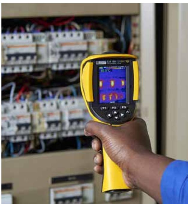
Abb. 1: Die Wärmebildkamera C.A 1954 DiaCam2
