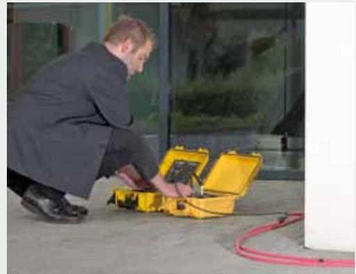
Abb. 3: Ableitstrommessung an einem Gebäudeteil
