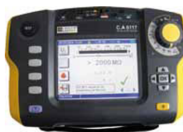
... und der Geräteprüfer C.A 6107 (Abb. 2) zur Überprüfung von ortsveränderlichen elektrischen Betriebsmitteln nach ÖVE/ÖNORM E8701
