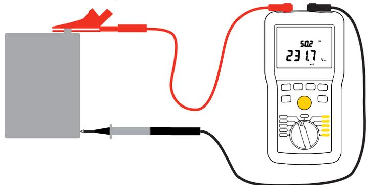
Das Gerät zeigt die an den Buchsen anliegende Spannung. Es erkennt, ob es eine AC- oder DC-Spannung ist. Im Fall einer Wechselstromspannung zeigt das Gerät die Frequenz (bei C.A 6524 und C.A 6526).
