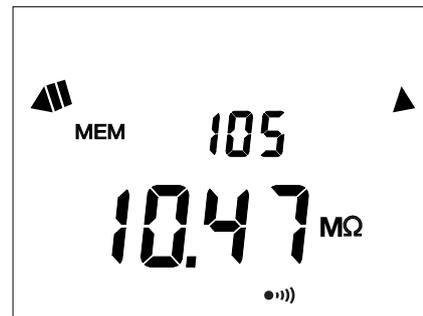
Zur Anzeige der anderen Messungen drücken Sie auf die Taste **▲**. Die Aufzeichnungsnummer wird hinunter gesetzt und die entsprechende Messung angezeigt.
