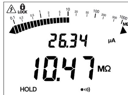
Anschließend drücken Sie lange auf die Taste **MEM**, der Messwert wird gespeichert.
