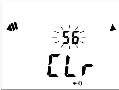
Anschließend drücken Sie lange auf die Taste **MEM**, um den Löschvorgang zu bestätigen.
