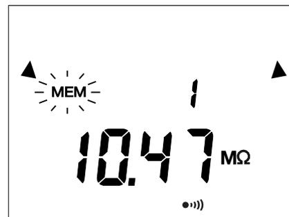
Alle Daten, die zur jeweiligen Messung gehören, werden mit abgelegt, auch wenn sie gerade nicht auf der Anzeige erscheinen (Spannung, Strom, bei PI und DAR die Prüfdauer T1 und T2 usw.).
