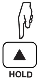
Mit der **HOLD**-Taste wird die Display-Anzeige „eingefroren“. Dieses kann für alle Funktionen außer Spannung in der Position **MΩ** durchgeführt werden.
