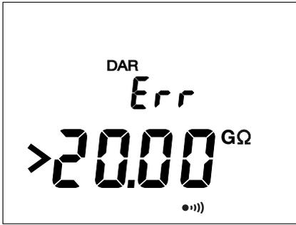
Bei C.A 6532, wenn dieser Fall beim DAR- bzw. PI-Messen auftritt, unterbricht das Gerät die Messung und es erscheint die gegenüber abgebildete Anzeige..
