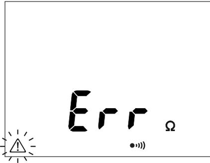
Sollte das Gerät bei Durchgangs-, Widerstands- und Kapazitätsmessungen eine externe Spannung > 15 V (AC oder DC) erfassen, unterbricht es die Messung und es erscheint die gegenüber abgebildete Anzeige.
