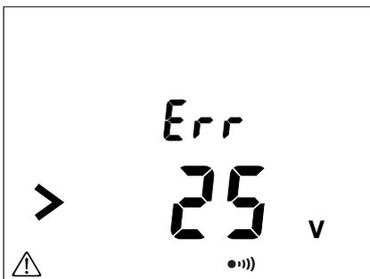
Vor der Isolationsmessung steht das Gerät auf Spannungsmessung. Sollte eine Spannung über 25 V an den Buchsen anliegen, und sollten Sie trotzdem versuchen, eine Isolationsmessung durchzuführen, erfolgt eine Meldung durch das Gerät.
