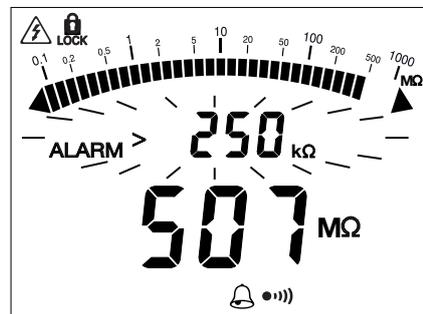
Im Beispiel oben hat der Benutzer somit rein akustisch und ohne auf die Anzeige schauen zu müssen die Möglichkeit, zu überprüfen, dass die Durchgangsmessung tatsächlich unter 2 Ω liegt. Auf diese Weise kann er auch den Zustand der Isolation kontrollieren.
