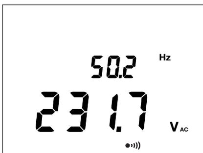
Bei den Schalterstellungen **MΩ** zeigt das Symbol
