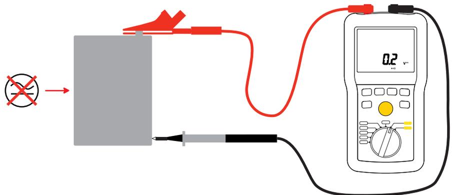
Drücken Sie die **TEST**-Taste und halten Sie sie so lange, bis der angezeigte Messung stabilisiert ist. Wenn eine Spannung 25 V erfasst wird, kann die **TEST**-Taste nicht betätigt werden.
