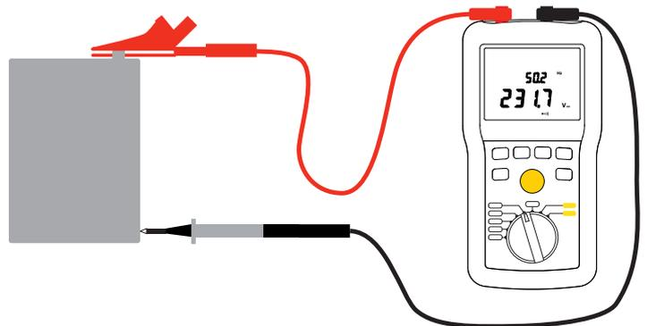
Das Gerät zeigt die an den Buchsen anliegende Spannung. Es erkennt, ob es eine AC- oder DC-Spannung ist. Im Fall einer Wechselstromspannung zeigt das Gerät die Frequenz an (bei C.A 6532).
