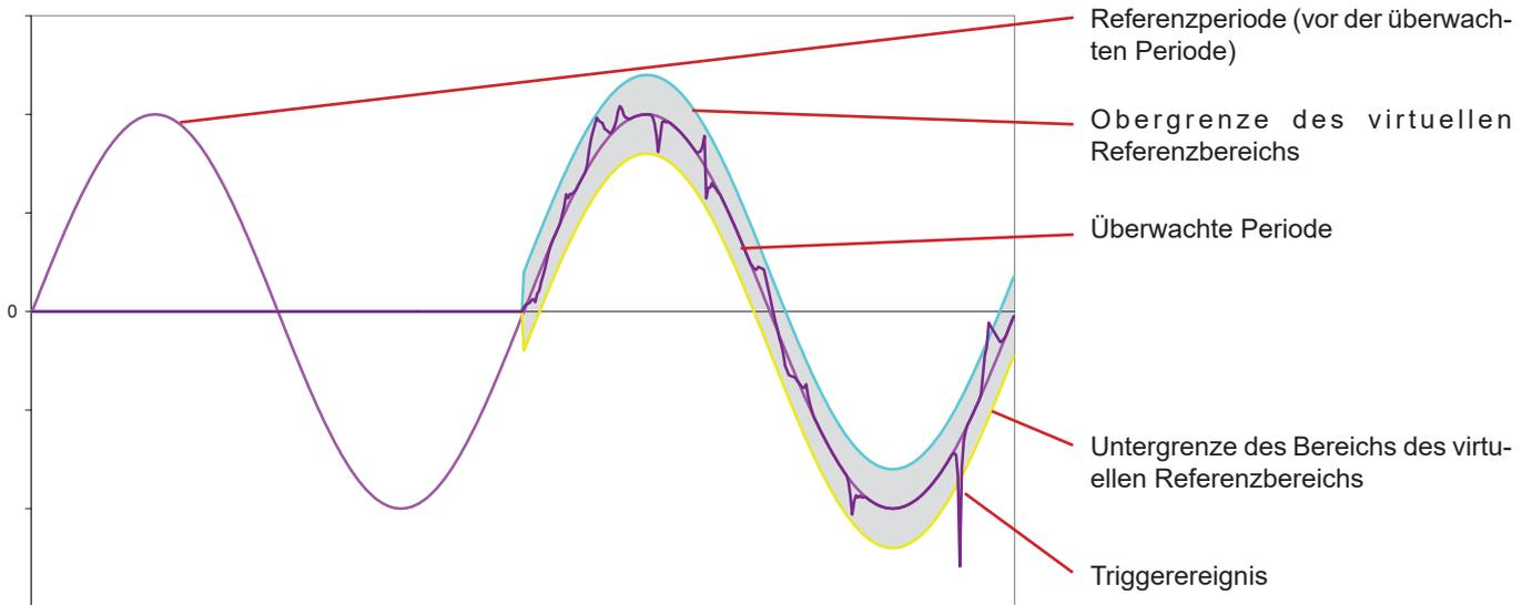
Die virtuelle halbe Breite des Bereichs für die Spannung und den Strom entspricht der im Transienten-Konfigurationsmodus programmierten Schwelle (siehe § 4.8).
