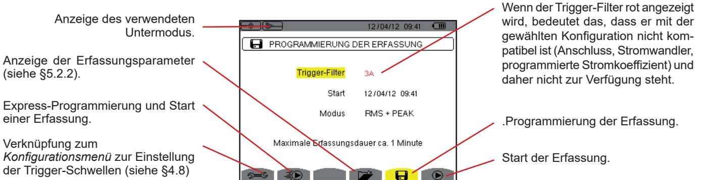
Abbildung 42: Bildschirm *Programmierung der Erfassung* im Modus *Anlaufstrom*
