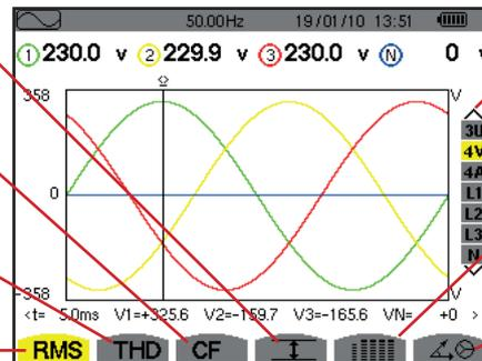
Auswahl der Anzeigefilter. Verwenden Sie die Tasten  $\blacktriangle$  oder  $\blacktriangledown$  zur Auswahl der Anzeige.
