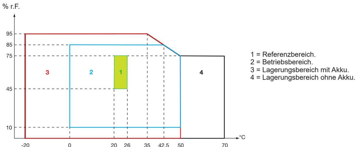
**Achtung:** Bei Temperaturen über 40 °C darf das Gerät entweder „nur mit Akku“ **ODER** „nur mit Netzteil“ betrieben werden. Der Betrieb des Geräts gleichzeitig mit Akku **UND** Netzteil ist **verboten**.
