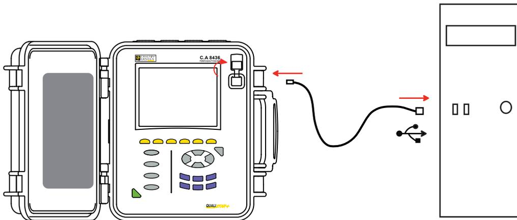
Setzen Sie das Gerät mit der Taste
