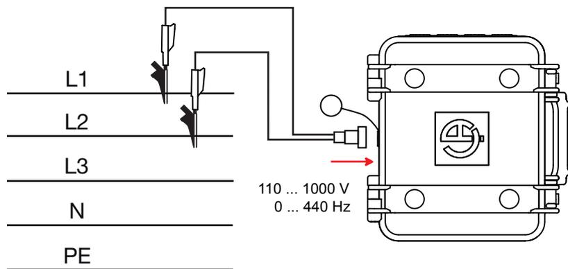
Wenn gemessen werden soll, während der Akku aufgeladen wird, schließen Sie die Messleitungen an die Eingänge und an die Sicherheits-Bananeinstecker an.
