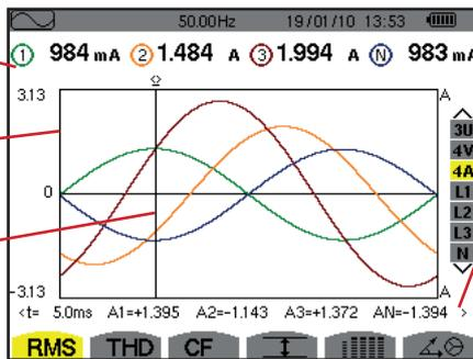
Momentanwerte der Signale an der Schnittstelle zwischen dem Cursor und den Kurven.
