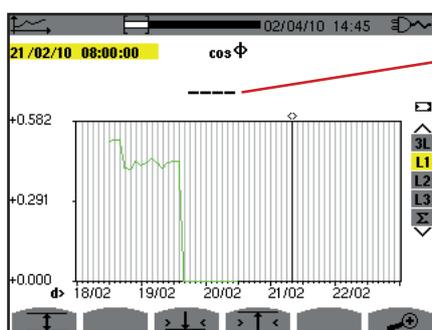
Die Striche bedeuten, dass an der Cursor-Position kein Wert verfügbar ist weil dieser nicht berechnet wurde.
