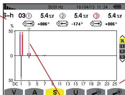
Cursor zur Auswahl der Ordnungen der Oberschwingungen. Verwenden Sie zum Versetzen des Cursors die Tasten ◀ oder ▶.
