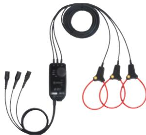
Das **MA 110** misst Stromstärken ab 80 mA und lässt sich an den AC-Spannungseingang ( $mV_{AC}$  /  $V_{AC}$ ) von jedem Multimeter oder Messgerät mit Bananensteckern anschließen. Das Modell **MA 130** ist für Drehstromnetze vorgesehen und lässt sich an den AC-Spannungseingang ( $mV_{AC}$  /  $V_{AC}$ ) von Leistungsanalysatoren, Recordern oder von anderen AC-Messgeräten anschließen.
