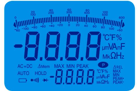
La gran pantalla LCD doble con retroiluminación azul consta también de una barra analógica con plena escala de 61+2 segmentos. El 0 central ofrece una visualización inmediata de las variaciones. Este tipo de barra analógica es muy práctico a la hora de realizar ajustes.
