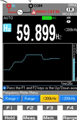
2. Wählen Sie den Frequenzbereich **Range ±** und < 200 kHz oder > 200 kHz
