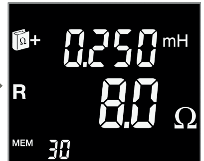
3. Anzeige: Wert des Widerstands- und Induktivitätsanteils der gemessenen Impedanz
