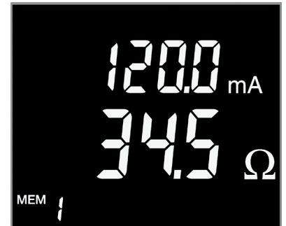
Standardmodus: Impedanz und Fehlerstrom
