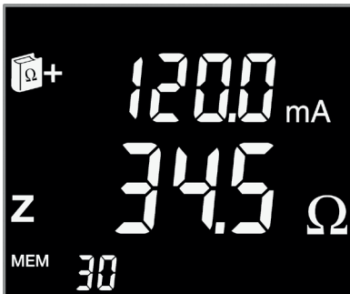
1. Anzeige: Impedanz und Fehlerstrom
