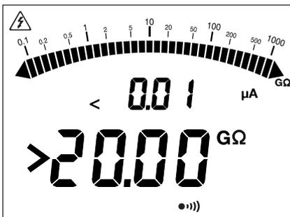
Durante la misura d'isolamento, se il valore da misurare supera la gamma di misura (che dipende dalla tensione di prova), lo strumento lo segnala.
