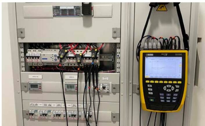
Leistungs- und Netzqualitätsanalysator, Qualistar Klasse A, CA 8345
