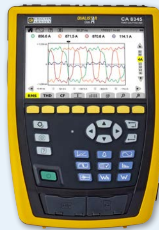
Bildschirm 2: Fehler mit Stromanstieg und Auslösung des Motorschutzschalters
