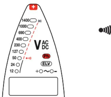
**Attenzione:** l'assenza di lampeggiamento della spia **Ph** non indica l'assenza di tensione pericolosa nella presa.
