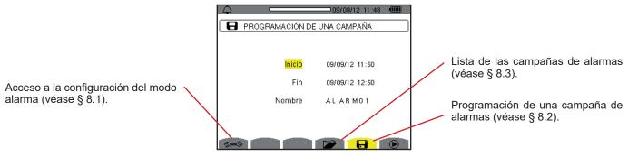
Figura 85: la pantalla del modo alarma
