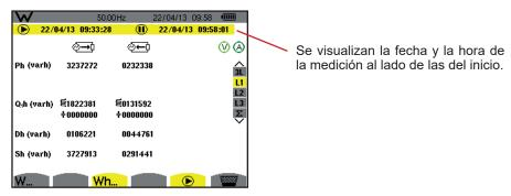
Figura 119: la pantalla de medición de energía en varh
