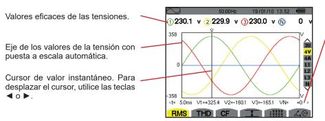
Figura 64: la pantalla de visualización RMS en 4V
