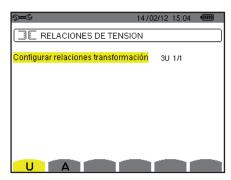
Figura 26: la pantalla Ratios de tensión en el menú Sensor y ratios en el caso de un montaje sin neutro
