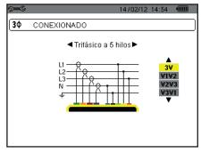
Figura 16: conexión trifásica de 5 hilos
