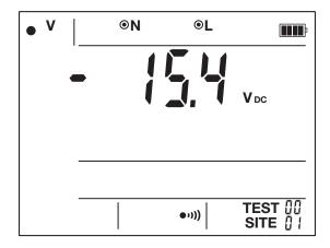
Bei einer spannungsführenden Messung (LOOP oder RCD) zeigt das Gerät mit dem Symbol die Stelle an, an der sich die Phase am Stecker befinden müsste. Wenn sich die Phase nicht auf der richtigen Seite befindet, blinkt das Symbol damit an, dass die 3-adrige Messleitung gewendet werden muss.
