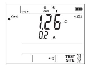
Solange die Messung zwischen einem Wert und OL variiert, schaltet sich das Gerät nicht aus, der Dauerbetriebsmodus P ist hier nicht erforderlich.
