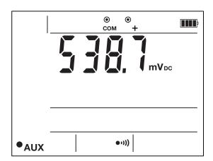
Diesen Spannungswert müssen Sie dann mit dem Wandlerverhältnis (RT) seines Stromwandlers in Strom umrechnen:
