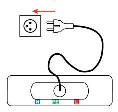
Der Messwert wird angezeigt. Das Gerät zeigt an, dass zwischen den Buchsen L und N gemessen wird. Daher besteht die Möglichkeit, 2 Leitungen zum Messen zu verwenden. Die Frequenz wird nur vom CA 6133 angezeigt.
