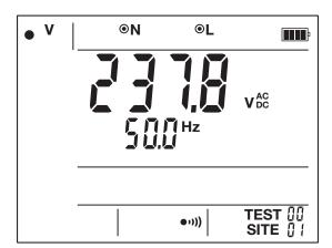
Das Gerät zeigt an, ob es sich um eine AC- oder DC-Spannung handelt.
