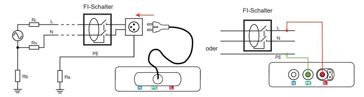
Das Gerät kontrolliert automatisch das Vorhandensein der richtigen Spannung zwischen den Buchsen **L** und **PE**. Ist dies der Fall, leuchtet das Symbol und die Prüfung ist nicht möglich. Bei U<sub>LPE</sub> < 90 V zeigt das Gerät abwechselnd U<sub>LPE</sub> und U<sub>NPE</sub> an.
