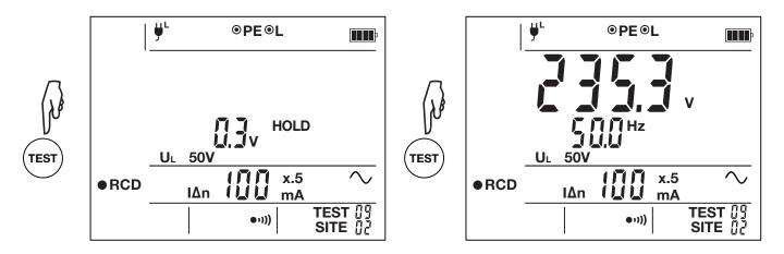
■ Drücken Sie die **TEST**-Taste erneut, um zur Spannungsmessung zurückzukehren.
