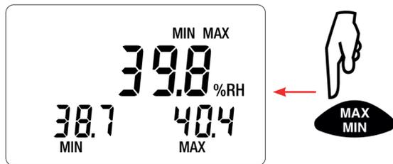
Anzeige der MIN MAX für die Feuchtigkeit
