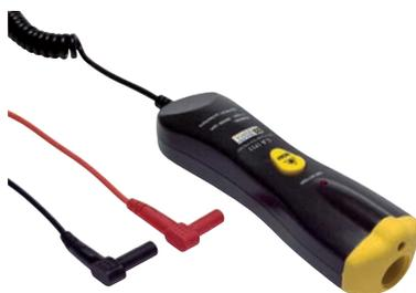
Berührungsloser Drehzahl-Sensor CA 1711 für Drehzahlmessungen (von 6 bis 120.000 min<sup>-1</sup>)
