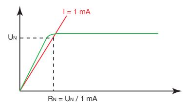
La gamma di funzionamento secondo l'IEC 61557 è di 100 k $\Omega$  a 2 G $\Omega$ . (vedi § 4.4).
