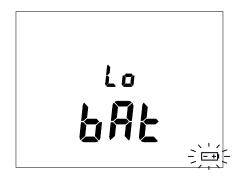
Occorre allora tassativamente sostituire le pile (vedi § 5.2), perché l'indicazione dell'autonomia non è più affidabile.
