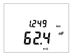
Lo strumento visualizza il valore della capacità nonché la lunghezza della linea corrispondente calcolata mediante la capacità lineica programmata.
