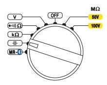
Come per una misura di continuità, collegate il dispositivo da testare ai morsetti dello strumento. Il dispositivo da testare non dovrà essere sotto tensione (vedi § 2.4.3).
