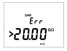
Per il CA 6532, se ciò si produce durante una misura di DAR o di PI, lo strumento interrompe la misura e visualizza il presente schermo.
