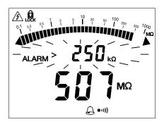
Nel precedente esempio, l'utente può anche controllare che la sua misura di continuità sia ben inferiore a 2  $\Omega$ , solo ascoltando e senza guardare il display. L'utente può controllare in maniera identica la qualità dell'isolamento.
