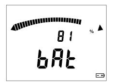
Se la tensione delle pile è troppo bassa per garantire il corretto funzionamento, lo strumento lo segnala.
