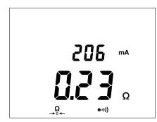
Lo strumento effettua direttamente la misura, visualizza il risultato nonché la corrente di misura.
