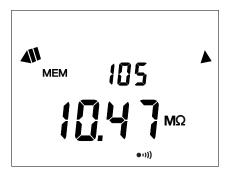
Per visualizzare una misura in particolare, utilizzate il tasto ▶ per modificare il numero di registrazione.
