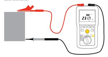
LLo strumento visualizza la tensione presente sui morsetti e rivela se la tensione è alternata o continua. Per il CA 6532, in caso di una tensione alternata, lo strumento visualizza anche la frequenza.
