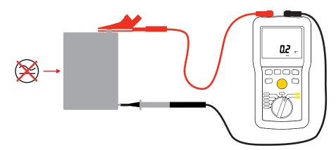
Premete il bottone **TEST** e mantenete la pressione fino a quando la misura visualizzata sarà stabile.
