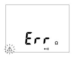
Durante la misura di continuità, di resistenza o di capacità, se lo strumento rivela una tensione esterna superiore a 15 V (alternata o continua), interrompe la misura e visualizza il presente schermo.
