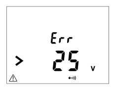
Prima della misura d'isolamento, lo strumento è in misura di tensione. Se la tensione presente sui morsetti è superiore a 25 V e ciononostante cercate di effettuare una misura, lo strumento lo segnala.
