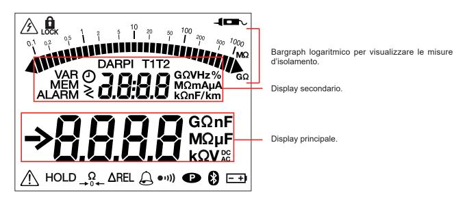
Quando la misura è inferiore al minimo, lo strumento visualizza - - - - .
