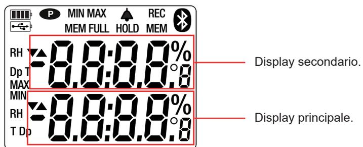
Quando la misura supera i limiti (in positivo o in negativo), lo strumento visualizza **OL**.
