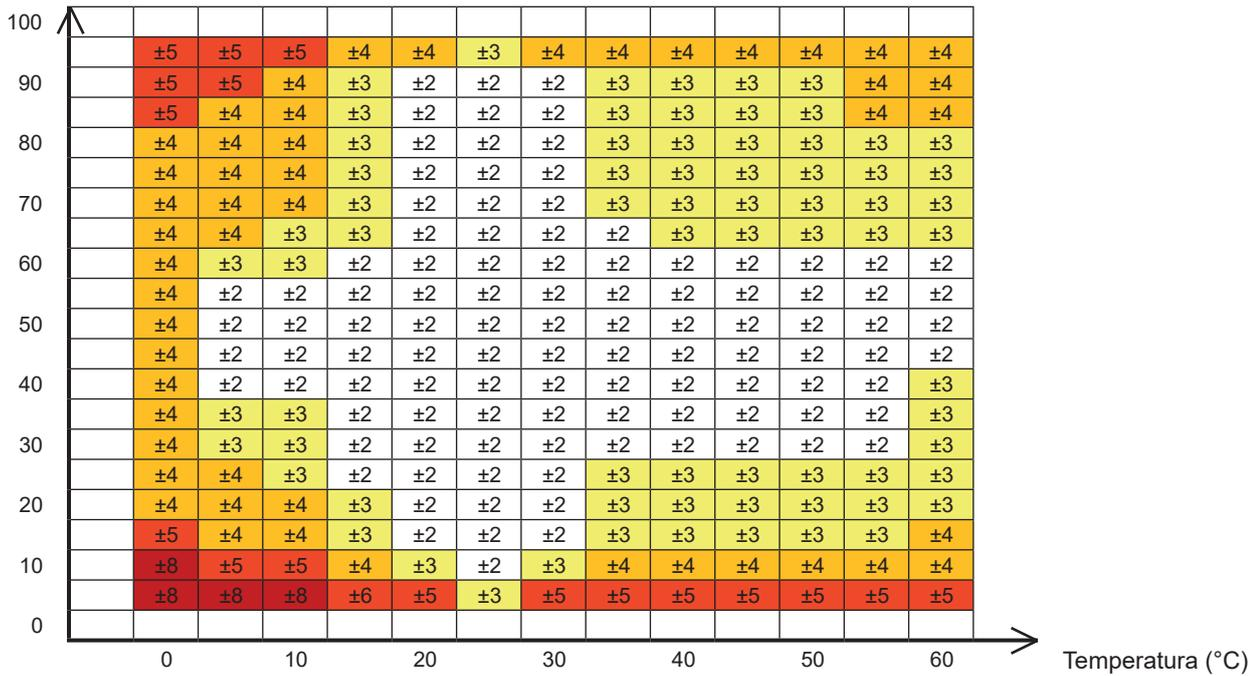
L'umidità relativa dipende fortemente dalla temperatura. Per realizzare una taratura dello strumento, i 2 sensori (quello di riferimento e quello dello strumento) devono indicare la stessa temperatura.
