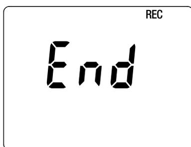
Se lo strumento visualizza il presente schermo in fase di avvio, ciò significa che una sessione di registrazione è stata brutalmente interrotta dallo spegnimento dello strumento in seguito a un'interruzione di corrente.
