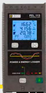
3 ingressi tensione, 3 ingressi corrente. Con quadruplo display digitale retroilluminato.
