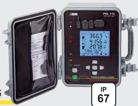
4 ingressi tensione, 4 ingressi corrente. Integrato in **una versatile valigetta da cantiere IP67**.
