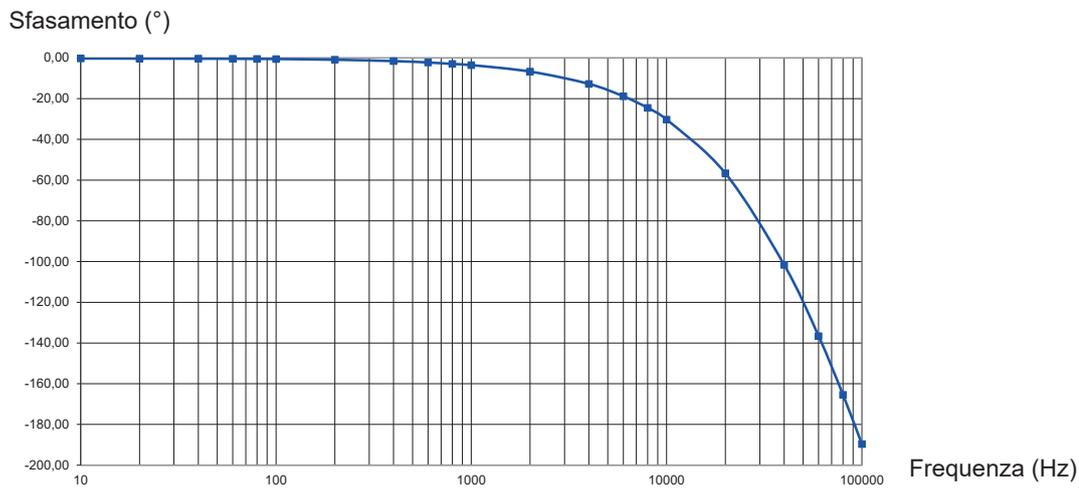
Curva tipica dell'errore di fase in funzione della frequenza,  $I = 0,5 \text{ A}$ , calibro 1V/A
