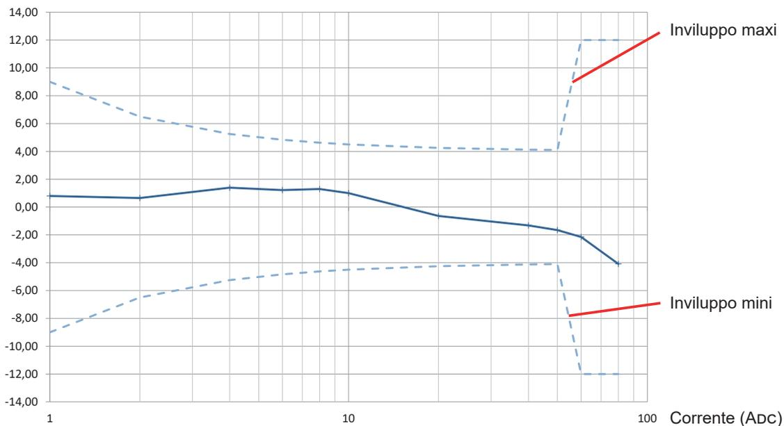
Curva tipica dell'errore in ampiezza per una corrente AC 60 Hz calibro 10mV/A
