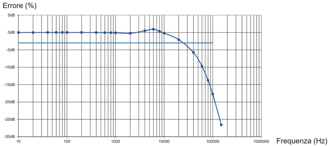
Curva tipica dell'errore di fase in funzione della frequenza,  $I = 1 \text{ A}$ , calibro 10mV/A
