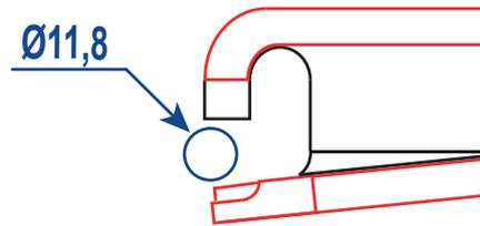
Capacità di serraggio: 11,8 mm di diametro
