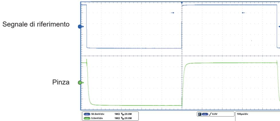
Risposta impulsionale a  $\pm 0,5$ A di cresta alla frequenza di 1kHz sul calibro 1V/A
