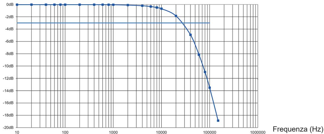
Curva tipica dell'errore in ampiezza in funzione della frequenza,  $I = 0,5 \text{ A}$ , calibro 1V/A
