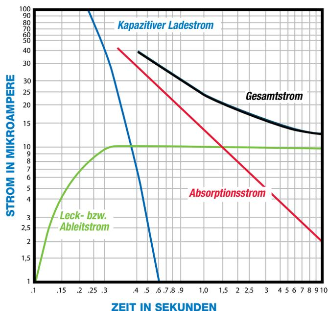
Der über die Isolation bei konstanter Prüfspannung abfließende Gesamtstrom unterliegt also mit der Zeit einer starken Abnahme oder in anderen Worten: der Isolationswiderstand nimmt mit der Zeit stark zu.
