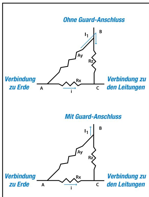
In der oberen Schaltung, ohne Guard-Anschluss, wird sowohl der Leckstrom  $i$  durch den Isolator als auch der über die Oberfläche abfließende Kriechstrom  $I_1$  gemessen. Der so gemessene Isolationswiderstand ist also falsch.
