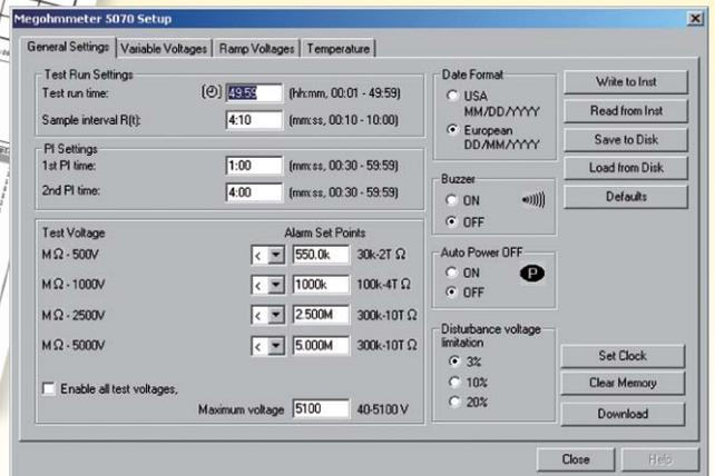
Die Dialogbox mit 4 Registerkarten ermöglicht eine einfache und bequeme Konfiguration der Messfunktionen des C.A 6549, wie z.B. Prüfspannung, Alarmschwellen, Spannungstufen und Temperaturkompensation.
