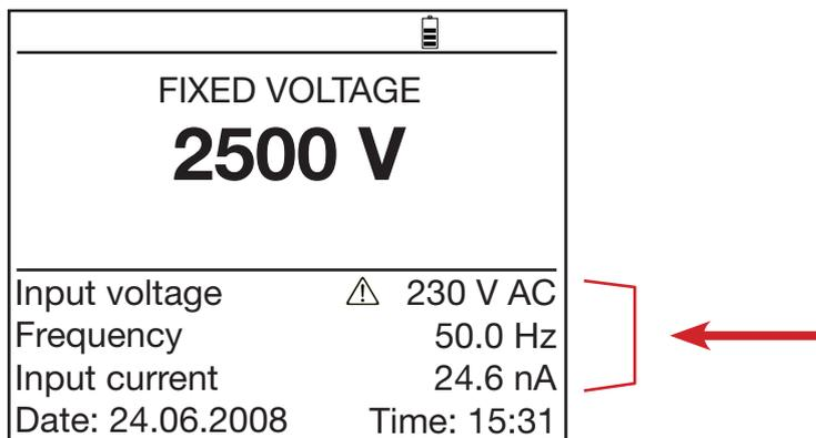
Wenn die anliegende Störspannung zu groß ist, ist keine Isolationsmessung möglich und das Symbol
