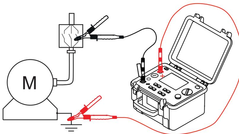
**Für die Messung hoher Isolationswiderstände (> 1 GΩ)** wird empfohlen, die Guard-Buchse „G“ zu benutzen, um Leckstrom-, Kriechstrom- oder Kapazitätseffekte auszuschließen. Die Guard-Leitung ist an eine Oberfläche anzuschließen, von der staub- oder feuchtigkeitsbedingte Oberflächen-Kriechströme ausgehen können. Diese Oberfläche kann z.B. der Isoliermantel eines Kabels oder die isolierende Oberfläche eines Transformators zwischen den beiden Messpunkten sein.
