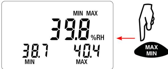
Anzeige der MIN MAX für die Feuchtigkeit
